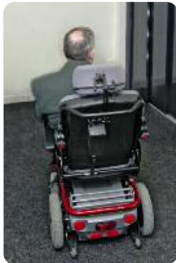
Les scooters électroniques sont assimilés aux fauteuils roulants. Il s'agit pourtant d'un matériel très différent, nécessitant l'usage des membres supérieurs pour le conduire au moyen du guidon. Ce sont des modèles à 3 ou 4 roues qui permettent, pour la plupart, une utilisation intensive à l'extérieur, notamment sur la route.
