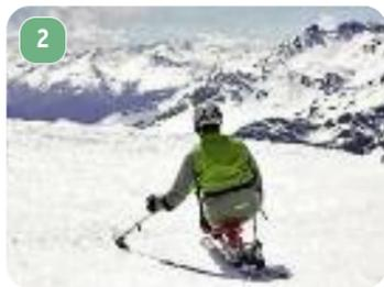
bras et du tronc. Le skieur est assis sur un siège fixé sur un châssis, lui-même relié à un ou deux skis. Le skieur est autonome ; il s'aide de stabilisateurs pour maintenir son équilibre et s'orienter.
